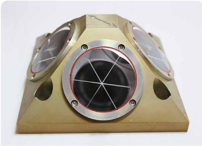
An den Satelliten sind Laserreflektoren montiert, die am GFZ entwickelt wurden. Sie werfen Laserlicht, das von ausgewählten Beobachtungsstationen abgestrahlt wird (darunter am GFZ) zurück. Aus diesen Messungen kann der Abstand zur Erde und damit die Umlaufbahn sehr genau bestimmt werden.
